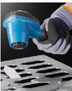
Mit dem Teileseparator TruTool PS 100 von TRUMPF lassen sich lasergeschnittene Kleinteile ergonomisch und schnell aus den Restgittern der Blechtafeln lösen.
